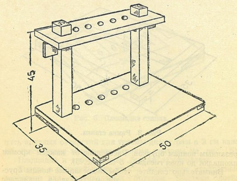
Рис. 2. Общий вид станка для сшивания.
