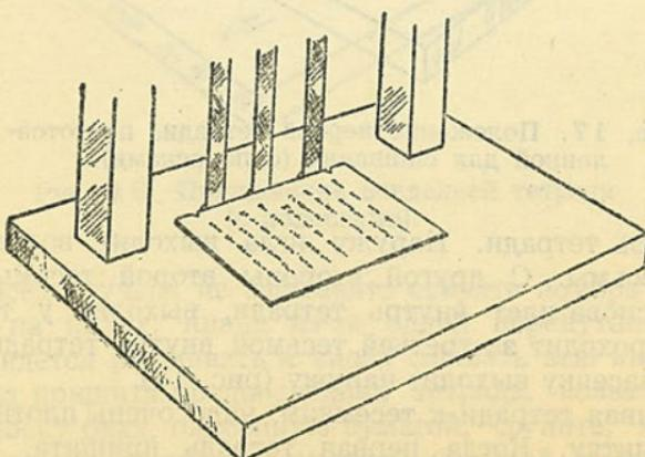
Рис. 16. Тетрадь в станке для сшивания.
